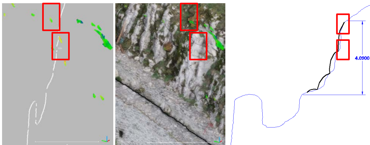
Slika 3.42 Realno nestabilni manji blokovi na preturanje na kosini LK2 (uokvireno crvenom)
