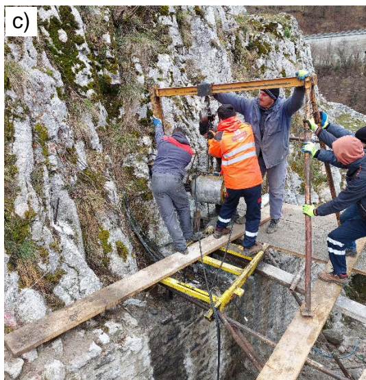
Slika 4.2 a), b) Izgled stenske mase u sidrišnoj zoni sidra br. 1 (bušotina B1) i br. 2 (bušotina B2), respektivno, c) postavljanje prese (multijack-a) i d) trenutak ispitivanja sidra br. 2
