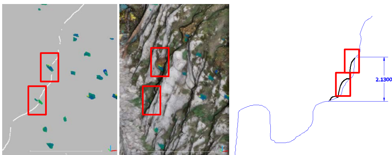
Slika 3.40 Realno nestabilni manji blokovi na savijanje na kosini LK2 (uokvireno crvenom)
