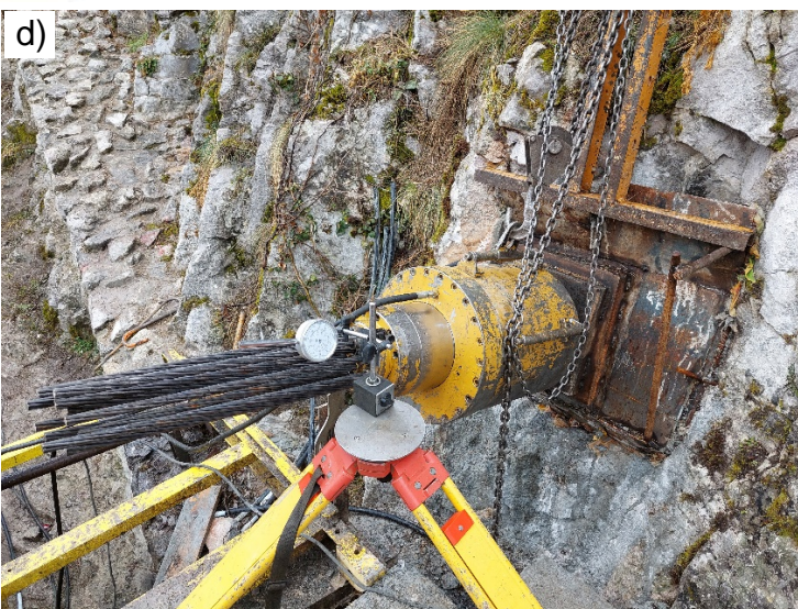
Slika 4.2 a), b) Izgled stenske mase u sidrišnoj zoni sidra br. 1 (bušotina B1) i br. 2 (bušotina B2), respektivno, c) postavljanje prese (multijack-a) i d) trenutak ispitivanja sidra br. 2
